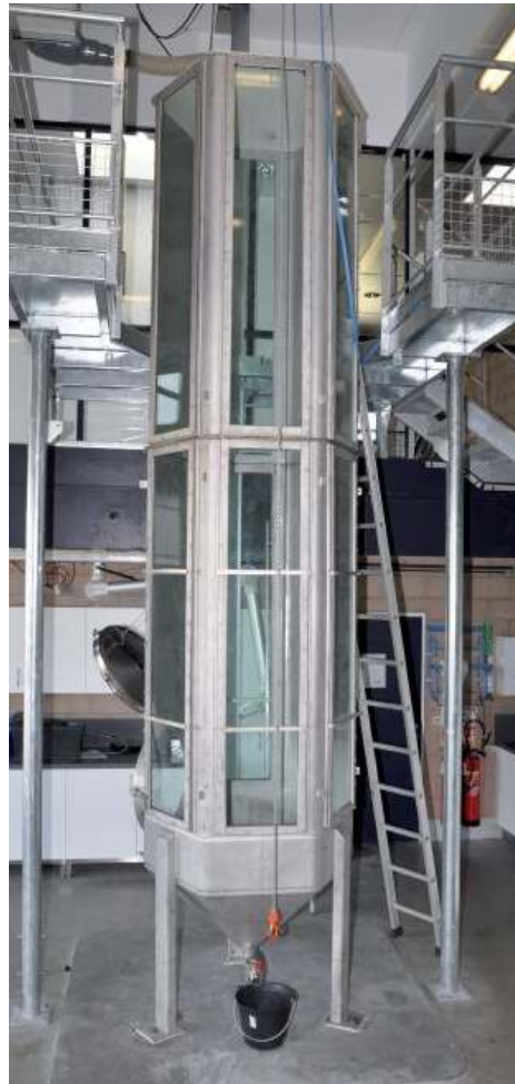
Figure 12. Colonne d'expérimentation du Cedre (©Cedre). Objectif : visualiser la formation et la stabilité des gouttelettes d'hydrocarbures dispersées dans la colonne d'eau.
