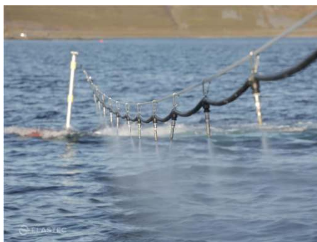
Figure 26. Rampe montée sur paravane (© Elastec).
