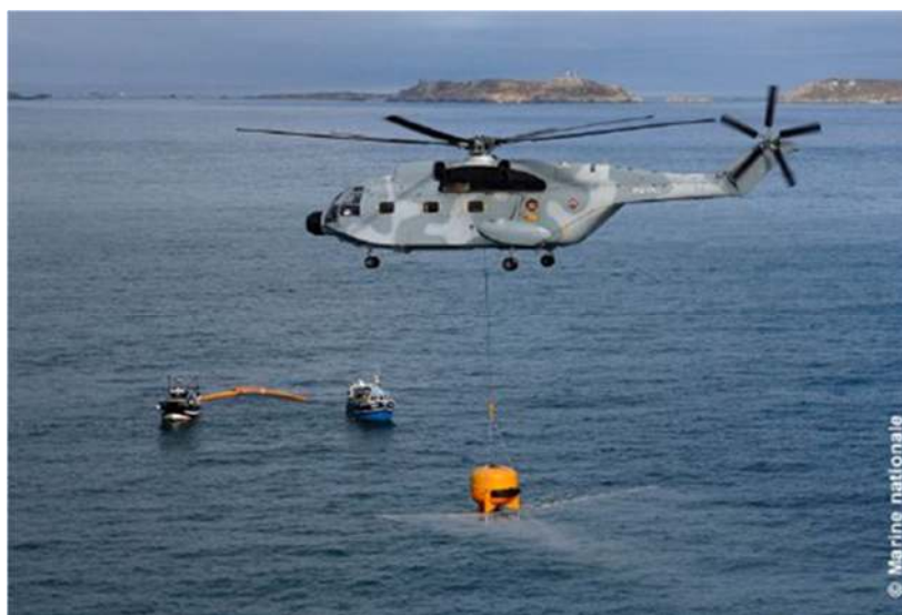
Figure 25. Cuve à dispersant héliportée utilisée lors d'un exercice Polmar-Terre/Mer dans les Côtes d'Armor (France) (© Marine française)
