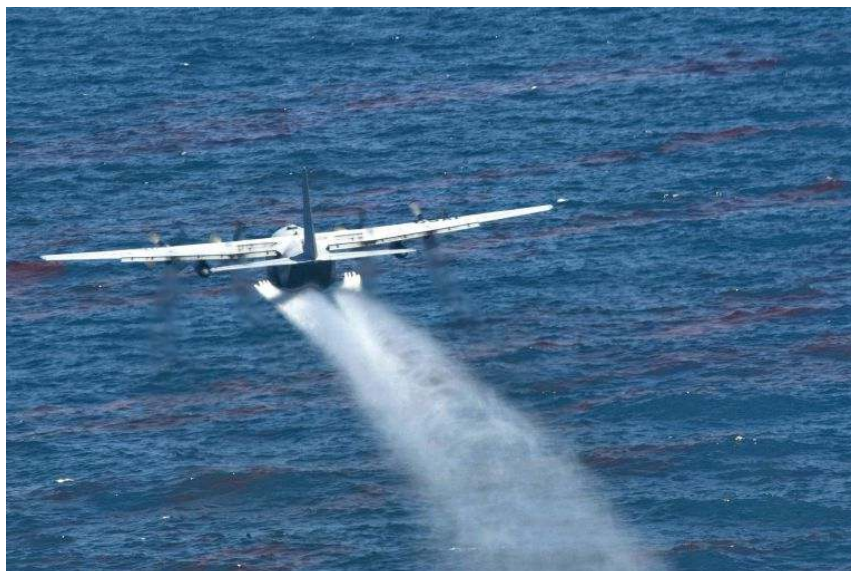
Figure 5. Un avion C-130 de l'U.S. Air Force qui épand des dispersants chimiques à la surface dans le cadre de l'intervention à la suite de l'accident de Deepwater Horizon (© photo de l'US Coast Guard)
