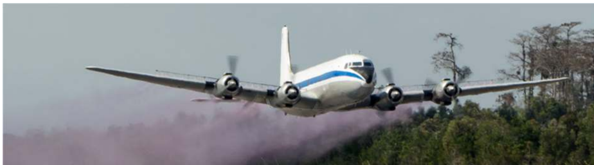
Figure 18. Exemple de systèmes fixes sur les ailes de l'avion. DC-6 de Florida Air Transport (N70BF) effectuant des tests d'épandage (Source: http://floridaairtransport.com/index.php ).
