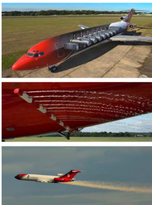
Figure 19. Système de dispersion TERSUS (©OSRL)
