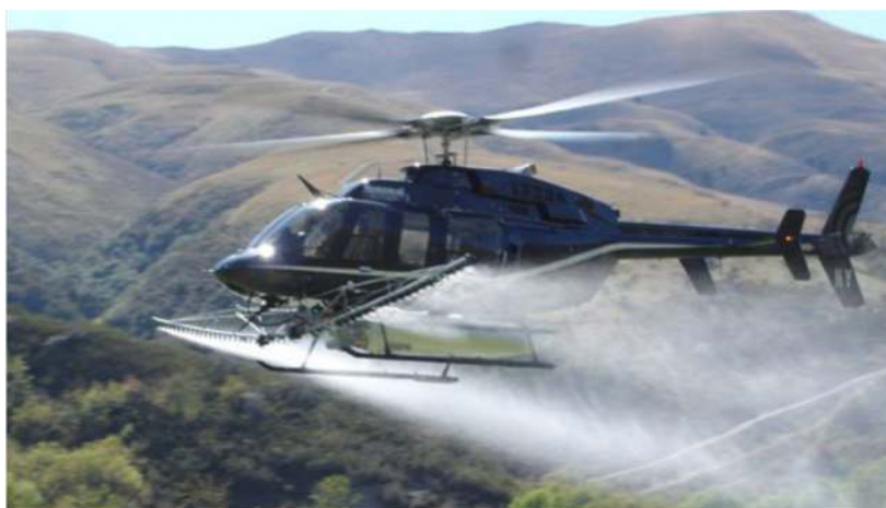
Figure 24. Systèmes d'épandage fixes pour hélicoptère (©Dart Aerospace)
