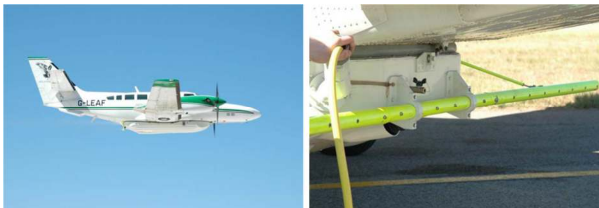
Figure 21. Avion avec module d'épandage POD (© Cedre).
