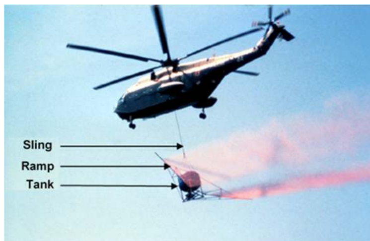
Figure 23. Hélicoptère lourd Super Frelon de la Marine française équipé d'un système à cuve (© Cedre).
