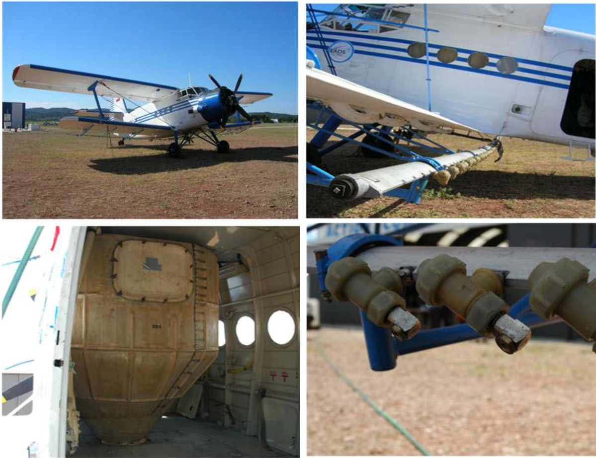
Figure 17. Avion d'épandage agricole (Antonov 2) (© Cedre).
