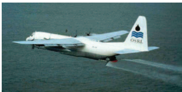
Figure 24 : Système d'épandage autonome à grande capacité (20t) fixé sur un Hercules C130
