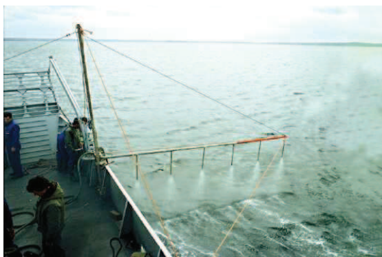
Figure 28 : Application de dispersants pré-dilués dans l'eau de mer
