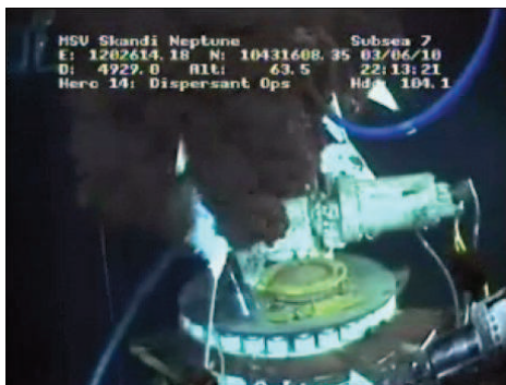
Figure 13 : Blowout en milieu sous-marin lors de l'accident du DeepWater Horizon (source : SINTEF)
